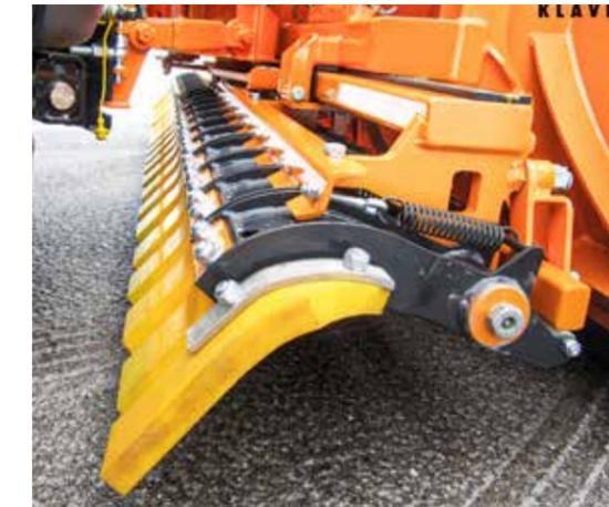
aufgelöst werden. Neben der Kostenintensität bleibt eine latente Gefahrenquelle bestehen. Das Nachräumklavier leistet eine perfekte Angleichung an unebene Fahrbahnen und liefert überzeugende Resultate.
